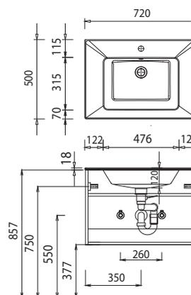
Bei Waschtischanlagen mit Befestigungsschrauben müssen die Maße zum Bohren vor Ort, nach dem Auflegen des Waschtisches auf den Unterschrank, angezeichnet werden. Waschtische ohne Befestigungskonsolen werden mit Silikon an der Wand und auf den Möbelseiten befestigt!
