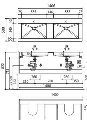
Bei Waschtischanlagen mit Befestigungsschrauben müssen die Maße zum Bohren vor Ort, nach dem Auflegen des Waschtisches auf den Unterschrank, angezeichnet werden.
