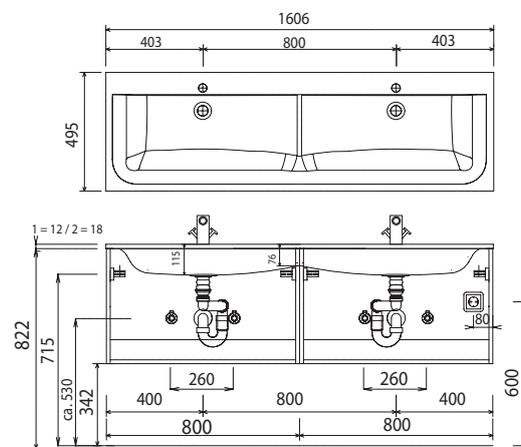
Bei Waschtischanlagen mit Befestigungsschrauben müssen die Maße zum Bohren vor Ort, nach dem Auflegen des Waschtisches auf den Unterschrank, angezeichnet werden.
